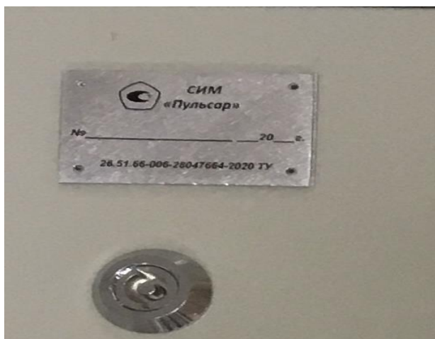
Рисунок 2 Пример маркировки систем
